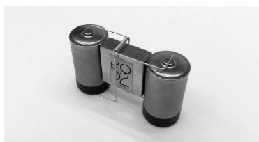
Fot. 2. Wygląd zbudowanej huśtawki elektrodynamicznej
