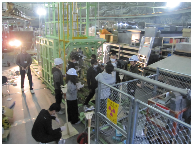
Zdjęcie z przygotowań do zbierania danych kalibracyjnych. Akcelerator znajduje się w bunkrze po prawej stronie. Na zdjęciu widać szarą rurę, którą przemieszczają się elektrony. Zbiornik z wodą jest poniżej – naukowcy stoją na górnej pokrywie detektora Super-Kamiokande. Widoczna na zdjęciu zielona konstrukcja służy do przechowywania i wprowadzania pionowych rur do zbiornika
