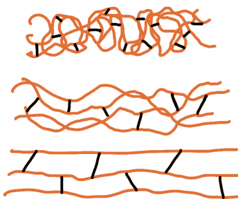
Zmiana struktury polimeru w trakcie rozciągania
